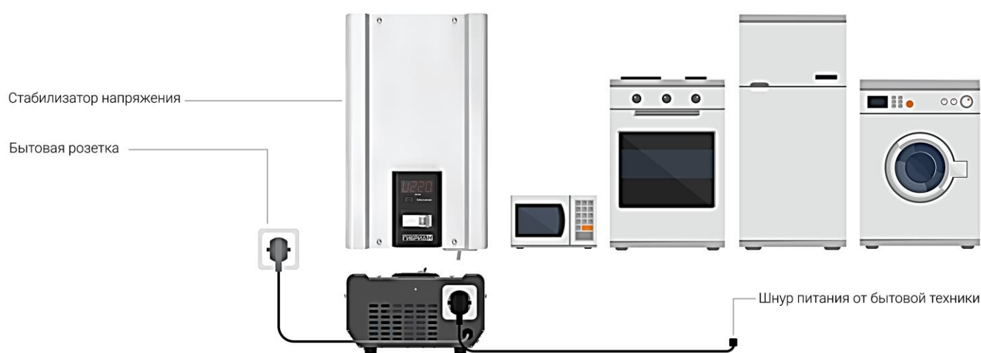
Рисунок 13. Подключение стабилизатора к сети
