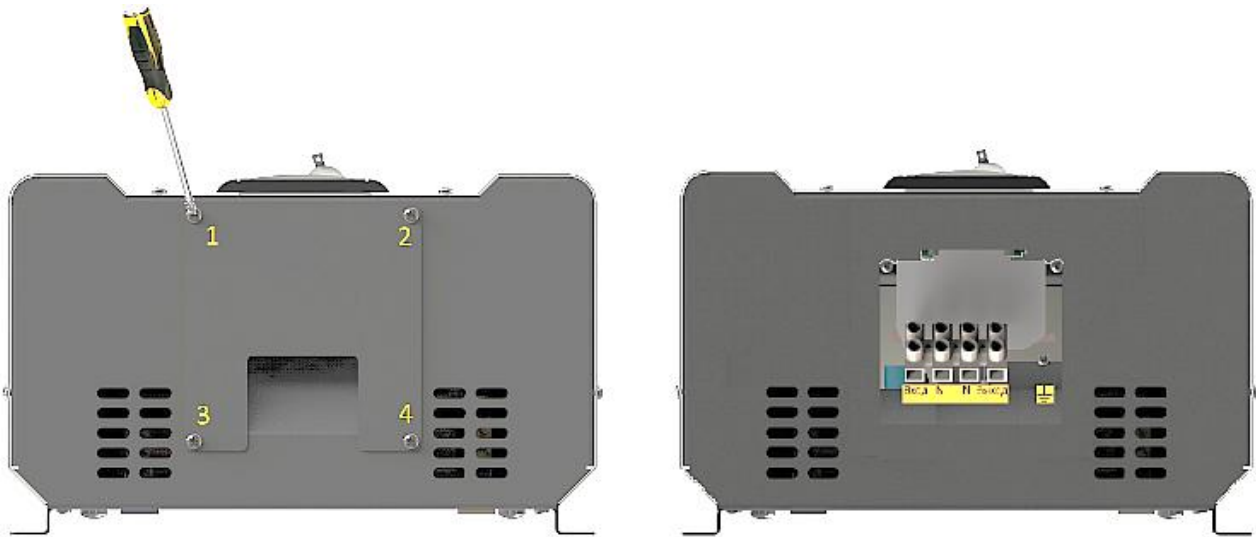
Рисунок 12. Схема снятия защитной крышки снизу корпуса стабилизатора
